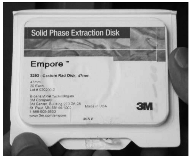
Fig. 3 Empore™ RAD disk for cesium
