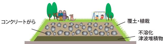
シーリングソイルパウダーで不溶化した津波堆積物を盛土として利用できます。また、コンクリートがら等の災害廃棄物を同時に盛土として利用することが可能です。
